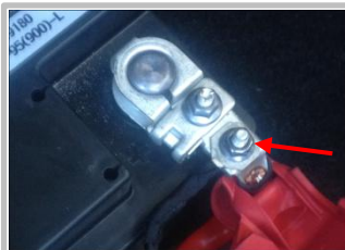
掀开红色原车正电极瓶盖，如图所示正极已安装好，还原拧紧螺母；
