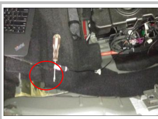
驱动盒装在尾门内部左侧此圆圈位置，固定好；
