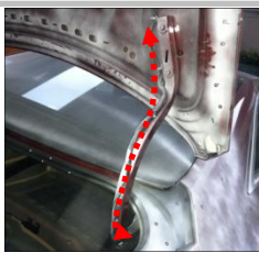
3.2 拆卸塑料扣，原车摇臂上的塑料件拆下，把 2 扎布线束（接开关、接门信号、）从尾箱左侧沿着摇臂延伸到上门锁（虚线）
