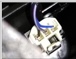
3.19 接尾门信号 ：原车蓝白线为开锁信号线借产品蓝色线，原车紫白线为状态信号线接产品棕色线
