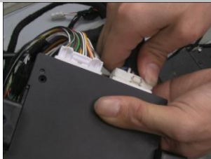
4.1 连接 ECU ，把主线束插头对应安装到 ECU 上，先大后小的顺序接上；
