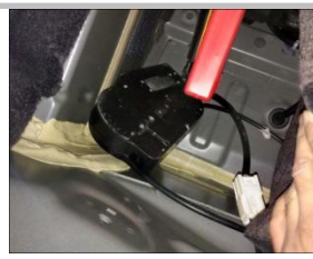
如图安装位置，需固定好，防止行车时松动；
