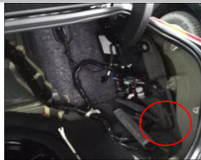
4.2 装 ECU ：把 ECU 安放在右侧底下此空旷处（圆圈），固定好防止松动，脱落；
