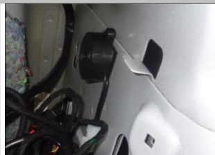
4.5 安装蜂鸣器 ：与 ECU 接头对接，并把蜂鸣器装在右侧装饰板内空旷处；（箭头）
