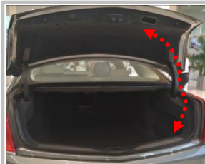
3.1 拆卸上门锁盖板，然后把线束如虚线穿到上门锁盖板；
