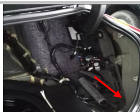
在尾箱右下方此内侧看到螺栓柱；
