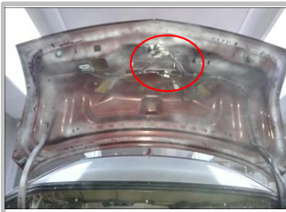
3.18 接尾门信号 在尾门上门锁扣位置找到原车信号；
