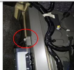
3.20 接负极：在右侧装饰板内找到螺丝，把我们的负极线搭上，松动螺母不用拆下，卡紧后再还原拧紧螺母；
