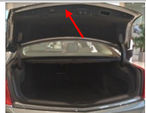
4.3 安装开关按钮 ：预留出安装开关的线束长度，把开关装上；
