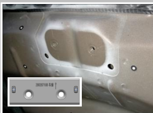
1.11 把我司垫板上，根据箭头朝向正确安装；
