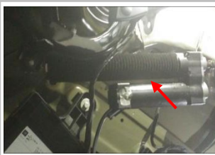
装撑杆总成：安装我们的撑杆利用原车安装点装上，一头卡在原车固定头，一头卡在我司万向上，如图已安装好；
