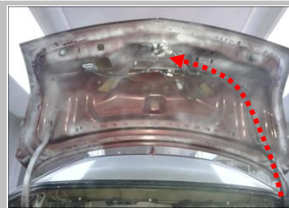
3.3 把 2 扎布线束（接开关、接门锁信号）延伸到尾箱上门锁扣处，延伸线用胶布或扎带固定好；（虚线）
