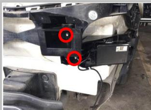
3.2、将雷达支架装到原车钣金上，用配给的标准件固定紧。
