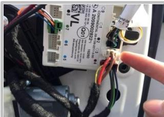
1.3、显示模块接线，将转接插头插入原车取电盒，连接好无线接收盒与蜂鸣器。
