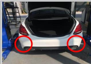
4.7、启动车子测试功能，在左右雷达检测区域用手靠近雷达运动，观察两侧三角板是否亮灯。
