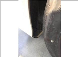
2.4、拆下挡泥板处的卡扣及螺丝。分为两层，外层3颗，内层2颗，M6螺丝一颗
