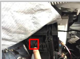
4.2、在图示位置取电（在上方靠左的两个均可取）
