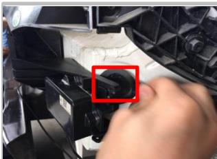
3.3、用扎带固定雷达线束，从图中的孔位穿进尾箱内部
