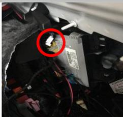
4.4、在模块上方找到此黄色插头，插头上方的棕、棕黄线。
