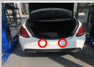
2.3、拆下包围与原车连接的2颗螺母
