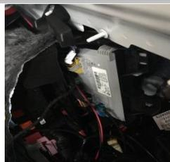
4.5、用线夹将我司绿色线接原车棕黄线，紫色线接原车棕色线。
