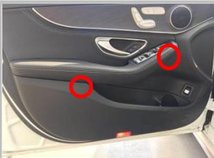
1.1、拆下原车螺丝，位置如图中红色圈所示，再用撬板拆下门板。（左右方法一致，只描述一边）
