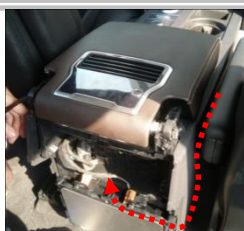
1.14 电机延伸线如图示意穿到手扶箱位置
