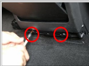
1.5 内部两颗螺钉拆下
