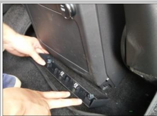
1.4 小心拆下原车卡扣连接位,拆下塑料件
