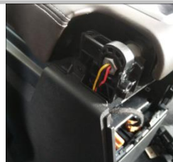
1.12 如图示意,左右两边固定位拧紧螺丝
