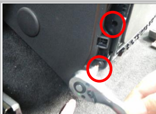
1.10 拆下左侧此处两颗螺钉,方便线束走线
