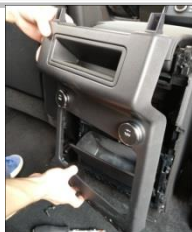
1.7 拆下原车后出风口面板
