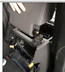
1.9 如图示意,拆下原车手扶箱
