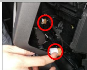
1.6 如图示意,暂时拆下原车两个插头
