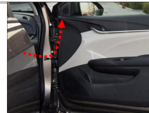
3.17、将右后视镜线通过门边波纹管引进门板内， 安装时，请务必按照原车的线路走向穿线
