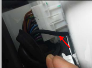
3.10、线束需穿过此波纹管，需在白色端子上，侧边使用斜口钳将侧边剪开，方便走线
