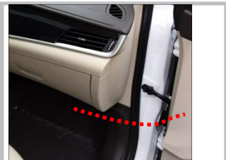
3.18、穿过右侧此处原车波纹管，连接后视镜（连接后视镜方式同左侧）
