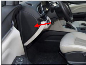
3.11 接 ACC、正极 ：在此位置找到原车车身信号线束； 注意接所有线束时预留足够线束后续对插 ECU
