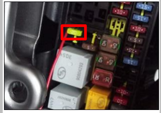
3.12、 接正极 ：看到原车保险盒内此位置为原车正极，拆下 20A 保险丝把我司正极线缠上再复原安装
