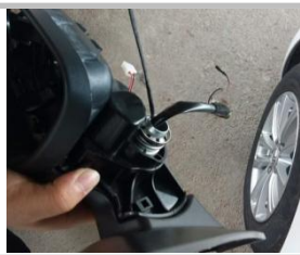
3.8、把后视镜以拆解的反顺序步骤将后视镜拼回去，还原为一个整体
