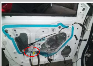
3.1、接信号线：在此位置找到原车车身信号线束； 注意接所有线束时预留足够线束后续对插 ECU
