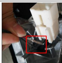
3.5、拆下的原车线束需安装在后视镜上，左右两边后视镜穿线方法一致
