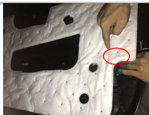
3.20、ECU 安装位置，把 ECU 固定在如图位置内侧
