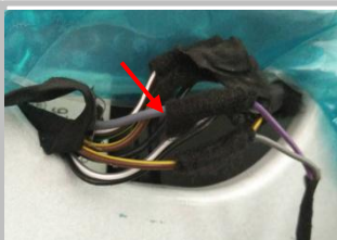
3.3 接信号线：上锁信号为灰色线
