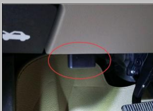
3.23、用我司 OBD 转接线对插，插头复原原车位置，线束插头固定好
