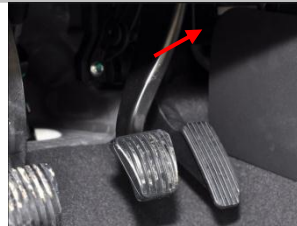
3.14、中控线束穿线位置，需固定好，切勿干涉脚刹位置
