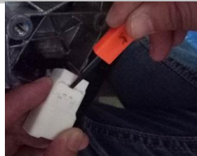
2.8、拆散端子：拆开连接器卡扣后，再挑出端子。（拆前拍下原车定义，方便后续复原）
