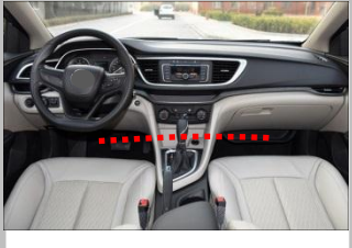
3.15、 穿右电机线 ：将此护板拆下，右电机插头从右门波纹管穿过
