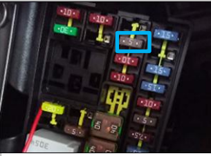
3.13、3.6 接 ACC ：拆下 5A 保险丝把我司 ACC 缠上再复原安装； 注意认准孔位安装
