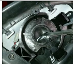
2.6、用螺钉撬起脱离周边卡扣，按顺序依次先拆下原车外壳、后盖； 注意小心拆下
