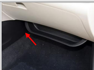
3.16、右后视镜从副驾驶室此位置穿过线，线束隐藏在地毯内
