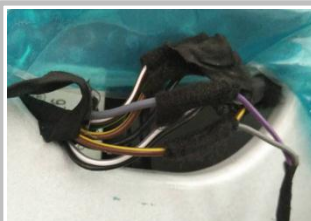
3.2、接信号线：原车有两根棕黄线，其中一根为解锁信号线， 解锁动作时，用试电笔测试灯亮为解锁信号线
