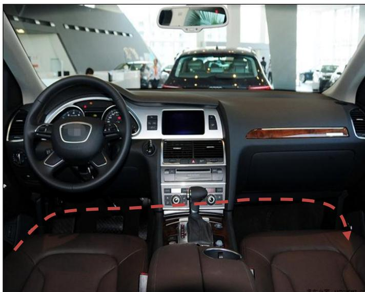
右踏板电机布线：把电机线通过脚下海绵，穿过副驾驶位。（虚线）
