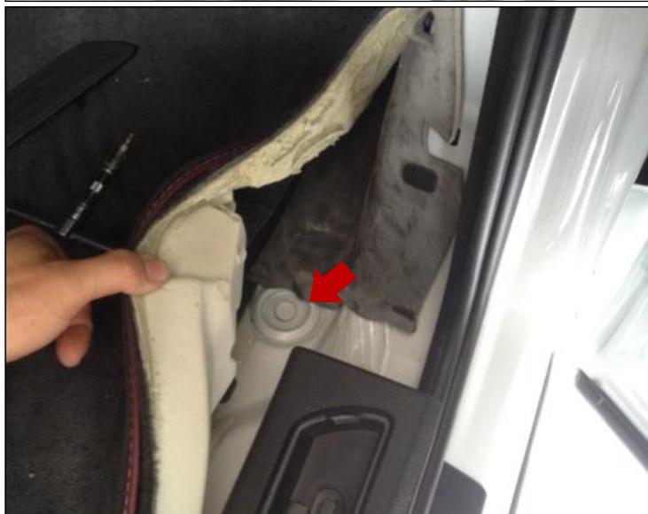
右踏板电机穿线孔：将右电机线由此孔穿过（箭头）
