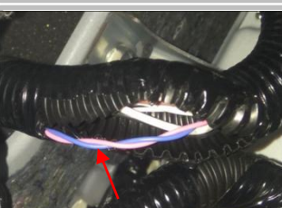
2.8、 接信号线 ：我司 白线接粉色线 ， 黄线接蓝色线 ；
