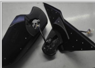
1.18、线束另一端穿过我司产品以及底座，再插回到原线束插头内；
