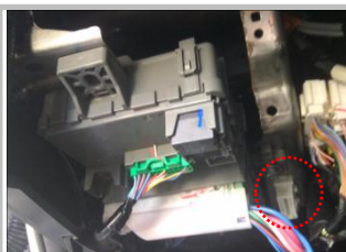
2.3、 接正极 ：在内部看到原车白色 OBD 连接器；
