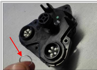
1.13、镜片调节器内部的铁丝圈可能会在拆解的过程脱落， 注意 将其安放回去；
