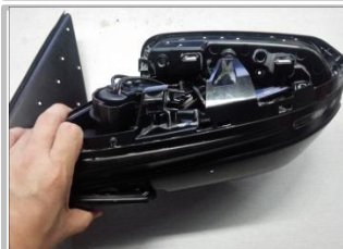
1.22、将后视镜整个拼装好，后壳先不要装上；
