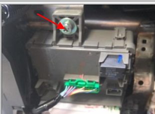
2.5、 接负极 ：在驾驶室中控台拆开盖板看到此原车螺栓，我司负极黑色线连接此螺栓；
