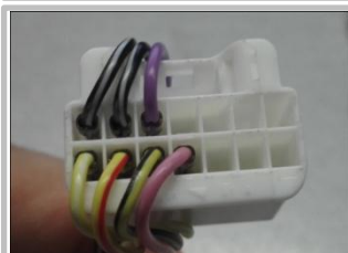
1.19、左后视镜插头上排从左往右分别是：黑白、黑白、紫、空格、空格、空格、空格；下排从左往右分别是：黄白、黄红、黄黑、粉、空格、空格、空格；
