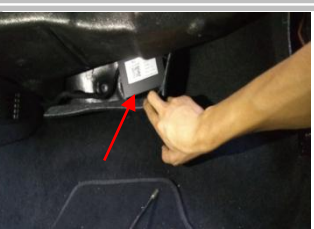
2.9、 安装 ECU ：线束对插，装在副驾驶毛毯内用 3M 胶配合底涂固定好在内部防止松动脱落；
