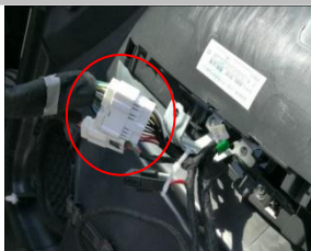
3.14、左门门锁马达转接头：在左门板位置找到原车插头与我司插头对插转接
