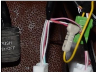
3.10、接背光源，原车红色线与我司黄色线用线夹夹紧
