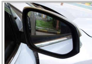
2.1、把原车镜片转到最倾斜之后取下原车后视镜镜片；
