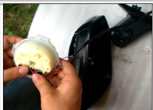
2.6、拿出转角器，再把转角器线束拆下；
