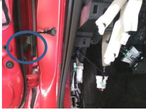
3.7、线束从右边经过橡胶处穿到门板上；
