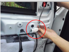
1.6、拆下此处后视镜连接器插头；
