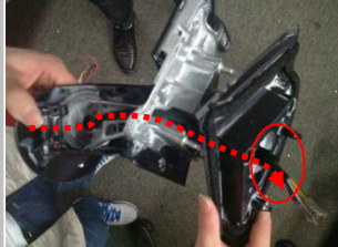
2.26、将线束穿过底座、软胶垫（虚线），用电工胶布包扎线束（圆圈）；
