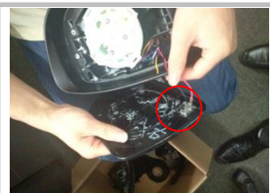
2.3、拆下镜片时，注意把这两根线拆下；
