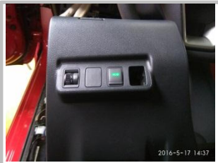
3.6、将左边的中控台位置和开关按钮拆下；
