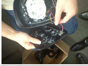
2.23、安装镜片，把线接好，对准卡位把镜片还原；
