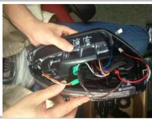
2.20、将绿色插座对接，黑色插座对接；
