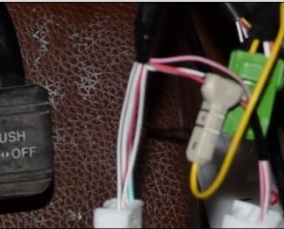
3.11、如背光源线束颜色不同按一下方法查找在汽车点火状态下用试电笔一端塔铁另一端逐个试原车中控开关线再不断的开启大灯试电笔亮则是背光源线束。
