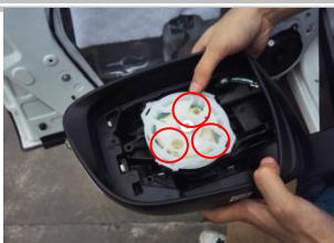
2.5、用工具将三颗螺丝固定螺丝拆下；
