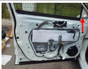
3.8、线束从橡胶处穿过来后和后视镜电机线对接；注意此处布线沿着原车走，防止玻璃升降干涉；
