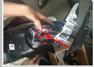
2.24、安装底座总成，用三颗螺丝固定，线束从此孔位出来；
