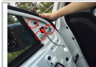
2.4、用工具把三颗螺丝拆下，取下原车后视镜；
