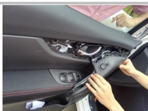
1.2、用翘板把扶手盖板拆下；
