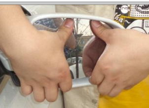
2.2、从下往上取出，防止破坏镜片；(图片为正面)
