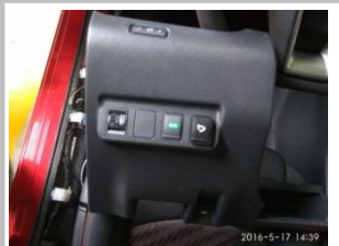
3.9、把我司配的中控按钮安装在此处位置，然后和中控开关对接；
