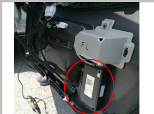
3.15、ECU 安放位置如图，置于门板此位置，以 3M 胶粘贴，扎带与凸出的塑胶件捆绑固定；
