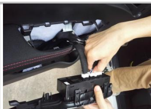
1.3、左侧门开关按钮处用撬板撬开，并将连接器拆下接头，
