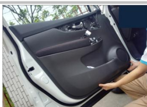
1.5、拆卸门板时脚顶住门，从下往上把门盖板卡扣依次松开，将门板拆下；
