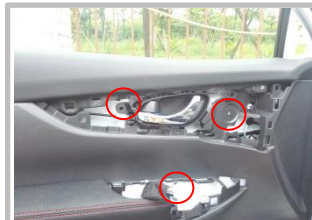
1.4、用工具将门板上的三颗螺丝卸下；
