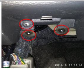
3.5、把这三颗螺丝拆下就可以将中控台面板和发动机盖开关拆下；
