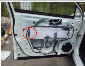
3.13、左门门锁马达转接头位于此圆圈内侧；
