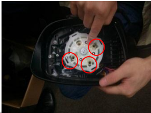
2.22、安装镜片转角器，用三颗螺丝固定；
