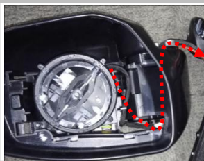
2.17、电机线和原车线束走位；
