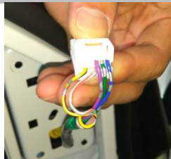
3.2 如图视角，下图视图方向，从左往右： 第一排：空格、空格、空格、紫、绿、蓝； 第二排：空格、黄黑、空格、绿红、空格、空格；
