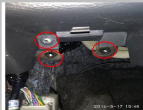
3.6、把此三颗螺丝拆下就可以将中控台面板和发动机盖开关拆下；
