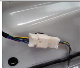
3.4、原车线束接好后和原车插座对接；
