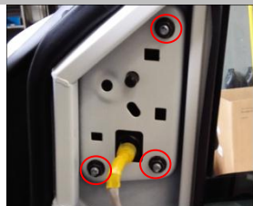
3.1、后视镜组装好后装上原车，用原车螺丝固定；
