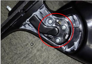
2.20、如图把底座还原，用工具还原三颗螺丝；
