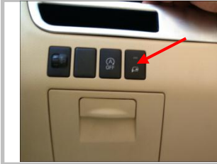
3.10、拆下此处原车按钮，把我司配的中控按钮安装在此处位置；
