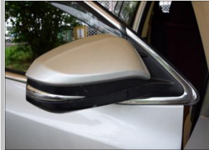
3.13、把后视镜还原安装时，注意原车与后视镜的间隙完全吻合；
