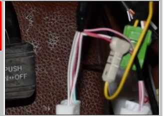
3.12、原车红色线与我司黄色线用线夹夹紧，线束固定好，防止掉落；
