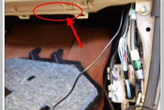
3.6、ECU 安装在副驾驶位中控台内部右上角，固定好，防止松动；(3M 胶需配合底涂使用)
