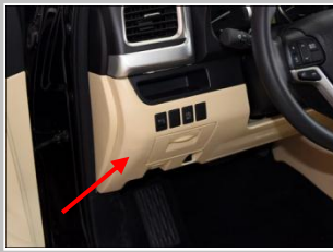
3.8、拆下驾驶室中控台装饰件；
