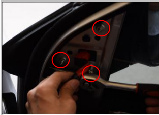
3.1、原车螺钉还原安装，固定后视镜；
