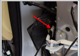
3.3、把延伸线穿过原先拆卸的波纹管；
