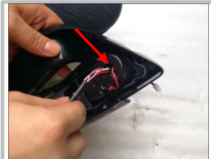
2.19、如图原车线束、电机线已穿过孔内；
