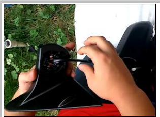
2.20、把原车线束、电机线穿过后视镜底座；
