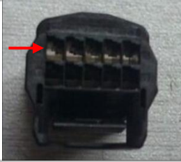
2.22、如图视角：(箭头)上排从左数起第一个孔插棕色线，紧接着第二个孔插红色线，第四个孔插白色线；
