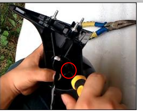
2.21、此处上3颗内六角平圆头螺钉 M5_12，固定底座；
