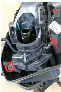
2.9、拆下手动支架 (1 颗螺钉及 2 各卡扣)。
