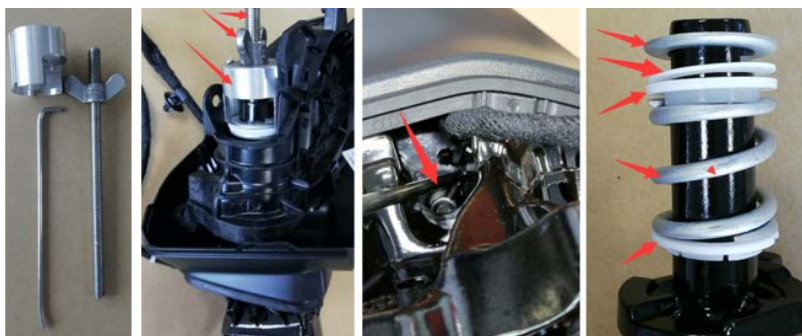
2.8、将套有压头、蝶形螺母的螺杆插入转轴中，用插销插入螺杆的孔中，然后旋转螺母，使压头将垫圈下压，压到弹簧垫片和 U 型扣脱离时，将 U 型扣拔出，然后释放压头，拆下弹簧及各垫片，并记住垫片的顺序。
