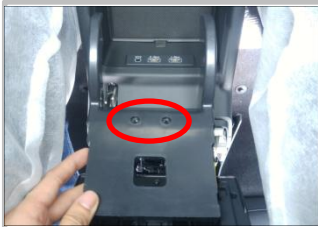
1.13 把支架盖套在原车支架外面，并用 2 颗螺钉固定；
