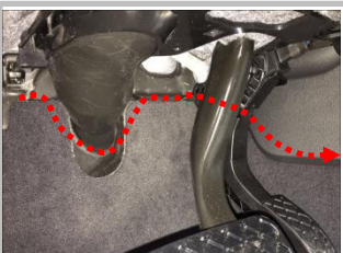
2.3 通过脚刹下面（虚线示）及座椅边缘缝隙隐藏，注意线束不要干涉脚踏板；
