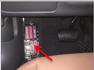
2.7 接 ACC/接正极常电 拆掉驾驶室左下角 A 柱盖板，看到此原车保险盒；
