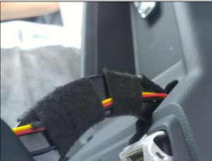
1.12 把电源线用毛绒胶布并排捆绑在右外侧缝隙处固定好；
