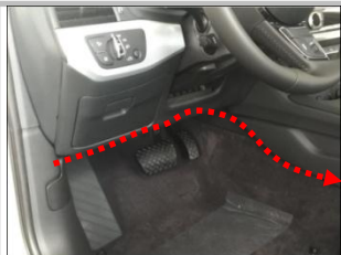
2.1 线束布置图,正极常电、ACC,搭铁在 A 柱完成接线；
