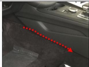
2.4 通过座椅边缘缝隙隐藏，延伸到手扶箱位置；
