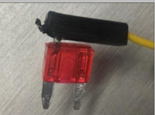
2.9 安装方式二接 ACC/接正极常电：需把插头拔出如图示意箭头位置脱离，预防安装时没有插到位，然后再正确插入保险盒内；
