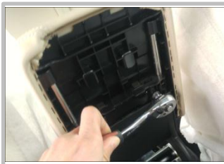
1.4 用套筒拆下原车左右对称两颗螺钉；
