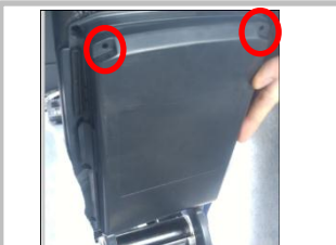
1.14 最后再把滤网盖装上，用两颗 M3 螺钉固定；
