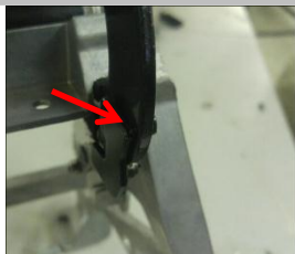
1.7 将阻尼连杆的一端，插进原车黑色支架的方孔内；
