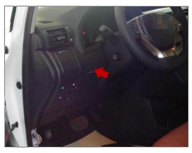
安装开关: 把开关安装在方向盘左下角附近空旷处,开关上的 3M 胶离型纸撕下,开关贴对应位置即可(箭头)
