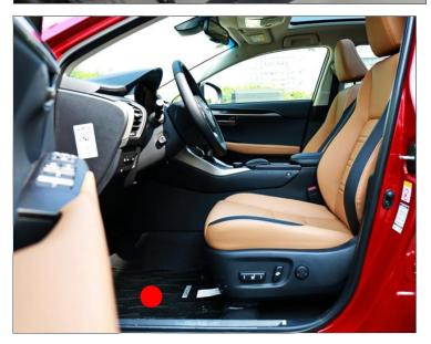
左踏板电机穿线孔:在驾驶位座椅底下对 应车底此处孔位(圆圈)
