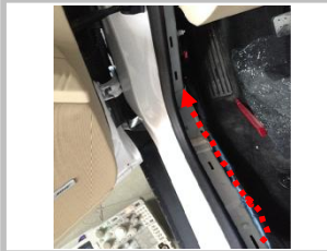
3.8 布正极线:把正极线从 B 柱引至前门迎宾踏板隐藏;(虚线)(同时布解码器控制信号线)
