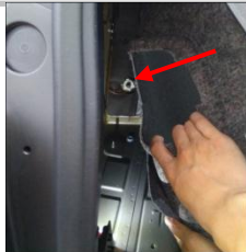
3.23 接负极 ：在左侧装饰板内找到原车有搭线的负极连接螺栓柱，把我们的负极线搭上
