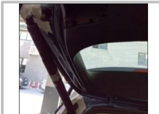
1.7 安装撑杆:把撑杆垂直固定头卡进装好的支架及万向头内, 确保卡稳固; 用同样方法安装另一边支架、撑杆
