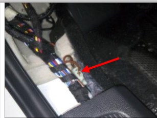
3.31 接解码器负极 ：在驾驶室左下角内侧边缘位置找到我们要接的负极，解码器线束中的负极（黑色线）需要在此处搭铁
