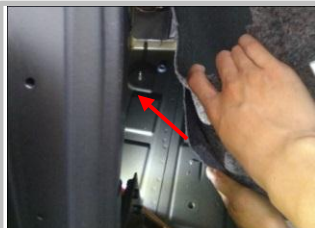
3.12 安装 ECU :与 ECU 接头对接, 并把 ECU 装在左侧装饰板内空旷处, 可自行调整
