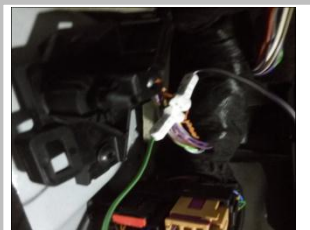
3.29 接解码器信号线 ：此扎原车线束剥开黑色胶布找到 橙绿色/橙棕色 双绞线，分别用线夹夹紧
