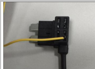
3.17 拆下保险丝, 把黄色线铜丝如图插入保险丝取电器内
