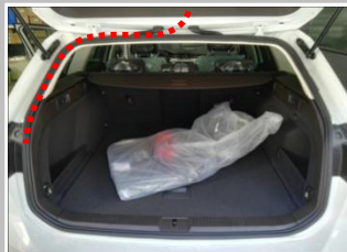
3.4 接开关、(门信号和解码器控制信号线)左右撑杆线束分布到尾门对应位置, ECU 放置在尾箱左侧
