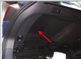
3.11 安装 ECU :安装 ECU :撕走魔术贴上的 3M 离型纸, 贴在 ECU 背部
