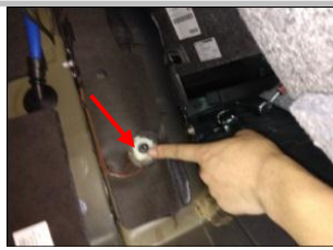
3.24 接负极 ：松动螺母，卡进负极连接片，卡紧后再还原拧紧螺母
