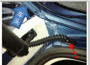
1.9 电机穿线孔: 把线穿过此处孔后, 用我司撑杆上的胶塞安装好; 另一边电机线同样安装. 注意胶塞安装到位, 防止进水.
