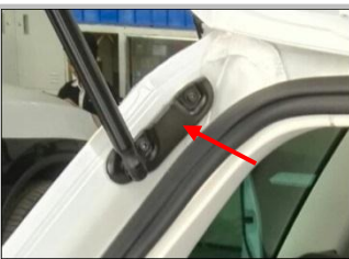
1.5 拆卸原车左侧支架
