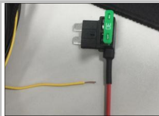
3.16 接解码器正极: 把我司解码器线束中的正极(黄色线), 如图示意连接到取电器内
