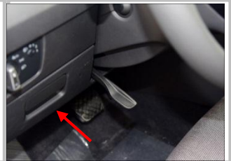
3.9 布正极线:拆下驾驶室中控台装饰件,看到原车保险盒
