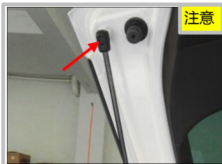
1.4 用一字螺栓刀把原车撑杆头翘起、拆下
