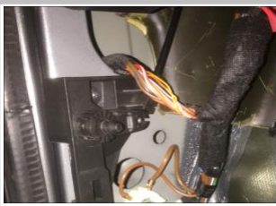
3.28 接解码器信号线 ：原车线束拆下黑色胶布
