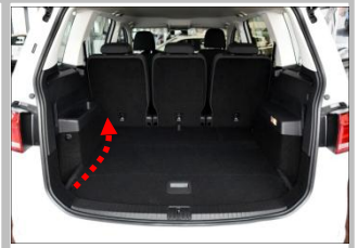
3.6 布正极线 将正极延着虚线引至左 C 柱;(同时布解码器控制信号线)
