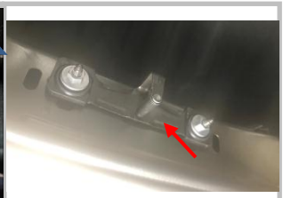
2.3 把我司门锁装上, 根据箭头朝向正确安装, 用原车螺母把门锁平行拧紧
