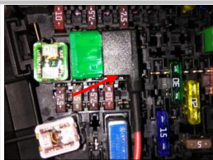
3.22 接正极 （尾门正极和解码器正极）：用保险丝取电器插上， 注意 取电器插头方向正确插入取电
