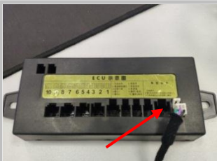
3.32 控制线的接线方法 ：解码器灰色控制信号线接我司 ECU 的开关延长线中黑色线，尽量靠 ECU 端接线
