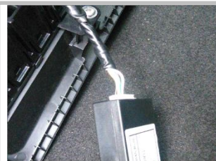
3.25 所有线束接好后把解码器放在主驾驶室 A 柱内侧位置并用魔术贴或电工胶布固定好
