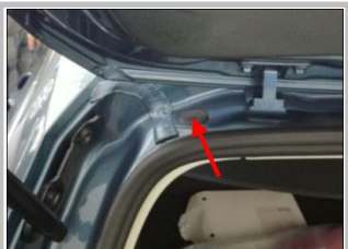
1.8 电机穿线孔: 拆下此处原车胶塞, 撑杆上的线从此处穿过
