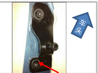
1.6 用我司配的左支架装上(支架箭头朝车头前), 箭头位置用内六角沉头螺钉 M6_20, 另一孔用原车螺栓安装, 如图已安装, 右侧支架同样安装
