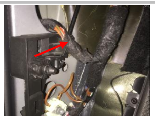
3.27 接解码器信号线 ：如图角度正视图内正确找到原车黑色线束
