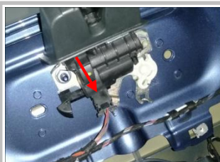
3.15 接门锁线: 用我们配的转接线连接, 再把我司转接线插头(箭头)插进上门锁; 注意如图拍摄角度
