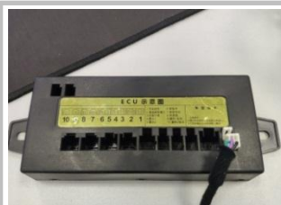
3.10 安装 ECU :把主线束插头对应安装到 ECU 上, 先大后小的顺序接上
