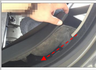
3.7 布正极线 将连接正极的线如图所示,通过尾箱后,把左 C 柱及迎宾踏板掀开线穿过将正极线引至 B 柱;(同时布解码器控制信号线)
