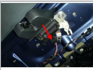
3.14 接门锁线: 上门锁扣背后如图此位置拆下原车插头连接器, 注意如图拍摄角度
