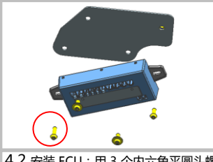
4.2 安装 ECU：用 3 个内六角平圆头螺钉 M6_15、1 个内六角平圆头螺钉 M6_20 (圆圈) 固定，配合 ECU 支架把 ECU 固定，
