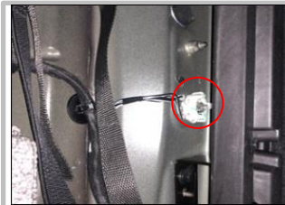
3.7 接负极：如图此原车螺栓柱接我司 ECU 与解码器负极拧紧；
