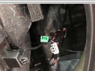
3.11 布 CAN 信号线：如图示意看到原车线束，找到原车紫白色紫绿色双绞线。
