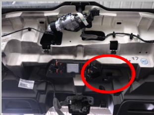
4.1 安装 ECU：ECU 安装如图所示位置 注意如图拍摄角度
