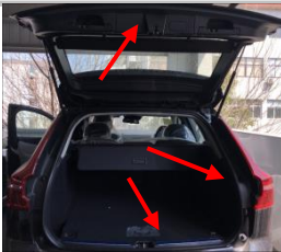
4.7 检查安装的螺钉是否全部锁紧，检查所有拆卸的装饰件是否全部锁紧，安装完成；
