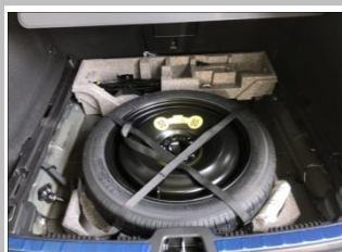
3.3 接正极线 拆开尾箱盖板看到原车备胎，原车电瓶在备胎下
