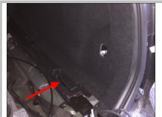
3.6 接负极：在尾箱右侧此位置找到原车螺栓柱
