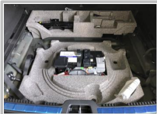
3.4 接正极线：把备胎拆下，看到原车电瓶
