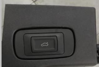
4.6 开关底座配合开关按键装在原车上，线束插头对插好
