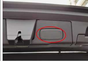
4.5 安装开关：此处拆下原车塑料件，用我们配的开关底座装上，然后开关按钮装上；
