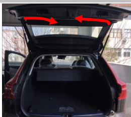
3.2 左右撑杆电机线对插撑杆插头
