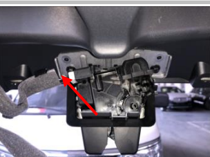
3.8 接门锁信号线：上门锁扣背后如图此位置拆下原车插头连接器，注意如图拍摄角度
