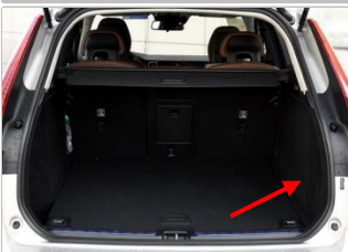
3.10 CAN 信号线：拆开尾箱右侧内饰板。
