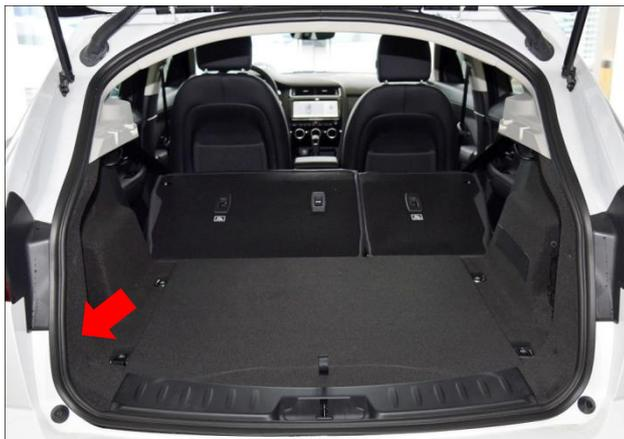
安装ECU：把ECU上的3M胶离型纸撕走贴在内壁部，线束用扎带在原车扎好固定，防止松动或脱落；
