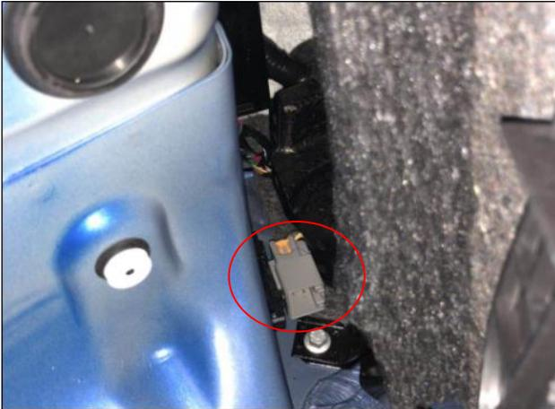
线束插头：在尾箱左侧找到此原车插头，用于连接我司线束插头。对插
