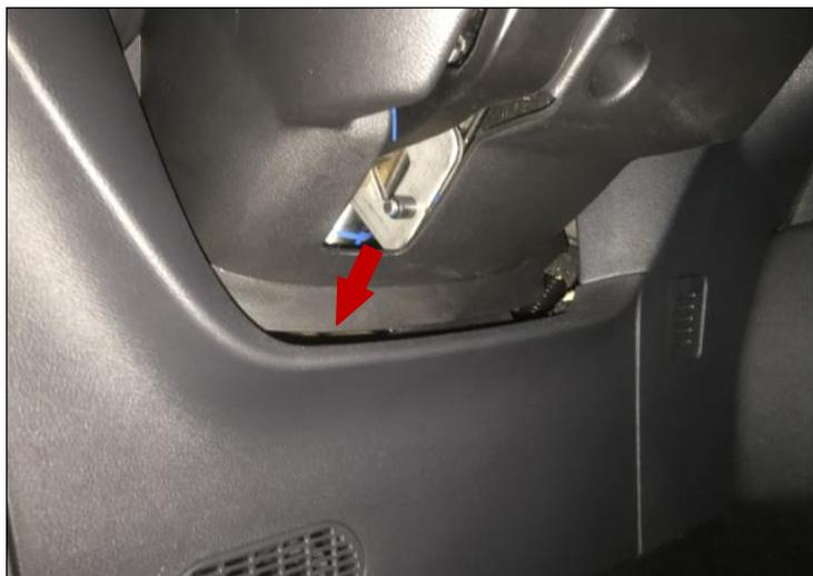
安装开关：开关上的 3M 胶离型纸撕下，开关贴对应位置即可（箭头）
