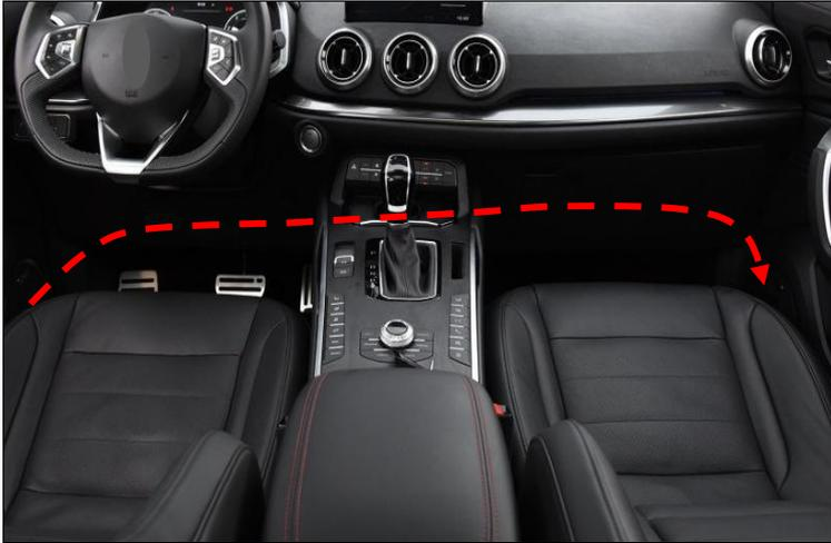
右踏板电机布线：把电机线通过脚下海绵，穿过副驾驶位。（虚线）
