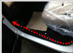
3.16 布正极线：掀开前门迎宾踏板胶条，正极线由此处延伸到驾驶室方向盘左侧；(虚线)
