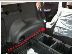
3.14 布正极线：首先把连接正极的延伸线从尾箱内侧穿到后门迎宾踏板处；(虚线)
