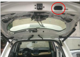
4.2 安装按钮开关 :此处拆下原车塑料件
