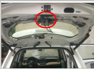
3.5 拆下尾门上盖板, ECU 安装如图示位置 注意如图拍摄角度
