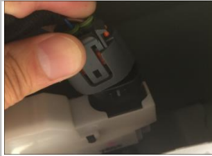
3.11 接尾门信号线: 在上门锁位置找到原车门锁信号线插头、拔下, 注意图片拍摄角度
