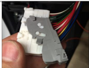
3.19 接正极：方法 1 推一下箭头此处的卡位，然后把灰色塑胶件拆下
