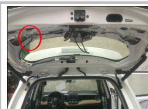
3.8 接负极: 在上尾门左侧附近此位置找到原车螺栓柱大概位置;
