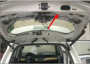
4.1 安装蜂鸣器 :与 ECU 接头对接 ,并把蜂鸣器装在上门锁钣金内空旷处
