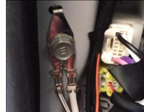
2.13 负极：负极在 A 柱下面位置看到不带油漆的螺栓柱，装上连接片拧紧；
