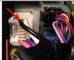
2.8 剥开原车黑色线露出铜丝，剪掉我司正极接头上的铜片，露出铜丝与原车捆绑缠紧，再用电工胶布包扎固定好；
