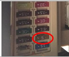
2.11 建议用原车对应 ACC 保险丝，取下一颗保险丝用带黄色线的保险丝缠上再还原插入保险丝位置；
