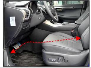
2.3 线束布置图,BATT,ACC,搭铁在 A 柱完成接线,通过脚刹下面(虚线示)及座椅边缘缝隙隐藏,有卡扣需拆开不用拆下内饰；
