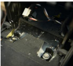
1.4 拆掉扶箱钣金与车身底盘 4 颗固定螺栓；
