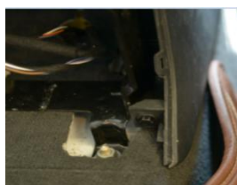
3.4 装手扶箱侧面塑料件下端与手扶箱钣金 2 颗螺栓固定
