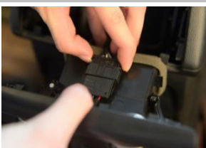
3.9 空调控制线束插入后排空调出风口
