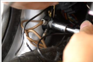
2.16 负极在 A 柱下面位置搭铁。
