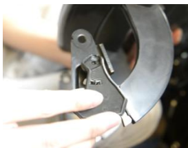
2.1 将“回位塑料件”安装到空气净化器支架
