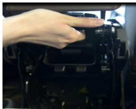
1.7 握住手扶箱钣金,将整个手扶箱往车后拉；
