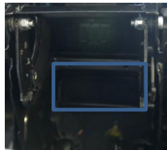
1.9 拆下后需用毛巾类物品将空调出风口堵上,以防后续拆装过程垫片掉落。
