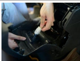
3.8 点烟器线束插入点烟器接头，后盖卡扣安装到位，复原
