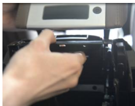
2.2 将空气净化器支架穿过原车支架槽,空气净化器放置到正确位置
