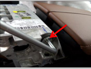
1.11 两侧同样撬开，安装时用我司配的转轴还原安装，两边对称安装
