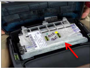
1.4 将手扶箱内箱与手扶箱钣金卡扣连接拆除，
