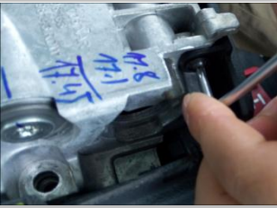
1.8 两边螺丝同样拆下；
