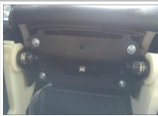
2.2 还原净化器支架与车身钣金连接的4颗螺钉,
