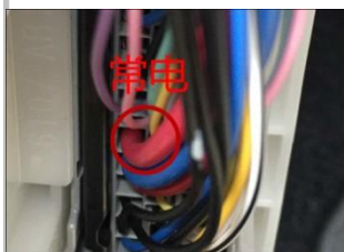
2.13 接正极:剥开原车黑色线露出铜丝,剪掉我司正极接头上的铜片,露出铜丝与原车捆绑缠紧,再用电工胶布包扎固定好;
