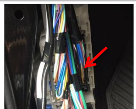
2.12 接正极:如图对应原车红色线接口为正极常电;
