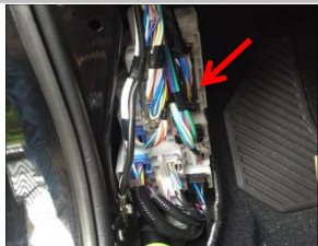
2.11 在驾驶室A柱左下角看到此圆圈原车正极接口大概位置;
