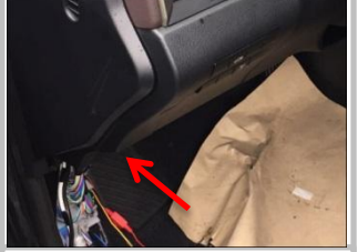
2.15 接ACC:在驾驶室中控台内侧拆下盖板,找到保险丝盒;建议不要让我们的保险丝插进去,将我们的黄色保险丝剪下来,剥线缠在原车保险丝上再插进去即可;
