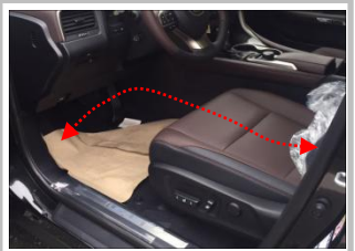
2.3 线束布置图,BATT,ACC,搭铁在A柱完成接线,通过脚刹下面(虚线示)及座椅边缘缝隙隐藏,有卡扣需拆开不用拆下内饰;
