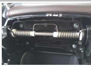
1.4 拆掉手扶箱支架与车身连接的4颗螺钉;
