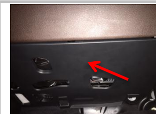
2.8 负极：拆下放脚盖板；
