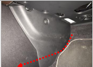
2.5 布线通过副驾驶室内部胶垫板；
