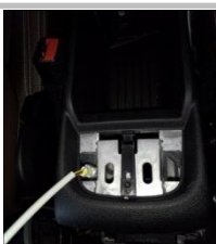
1.5 装上净化器,后续布线时电源线从图示孔插入；
