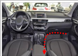
2.4 线束沿着虚线隐藏好,延伸到手扶箱位置,线束插头对接好；
