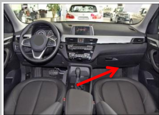
2.1 拆下副驾驶位右侧下角内部位置装饰件,线束连接在此处；
