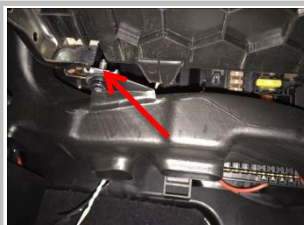
2.9 如图此塑料板处螺钉连接负极；
