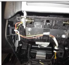
1.10 螺钉复原 线束如图示安装,用扎带固定；
