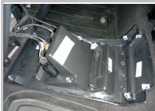
1.7 出风口面板已拆下；
