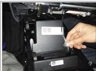
1.6 同时内部线接头拆下；
