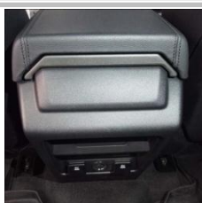
1.5 把出风口面板用撬具拆下；
