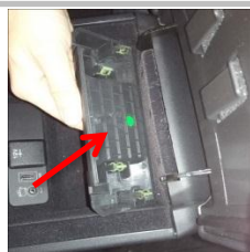
1.3 如图盖子卡扣脱离连接位；
