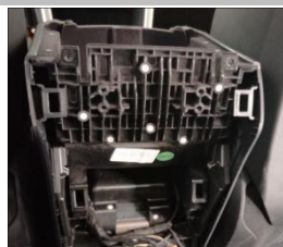
1.8 原车手扶箱已拆下,安装产品顺序与拆卸相反即可；
