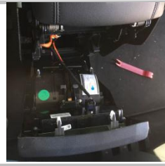
1.6 同时内部线接头拆下；
