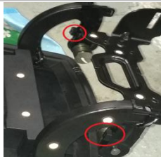
1.11 拆原车手扶箱盖板铁架上的胶垫配件（左右对称 共 2 个） 配件借用到净化器支架上
