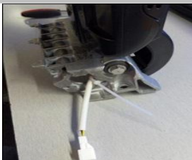
1.13 用扎带锁紧电源线，需开合净化器， 注意 ：验证电源线不会被磨损，防止干涉线束；
