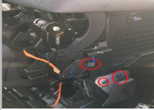
1.7 拆下螺丝（左右对称 共 10 颗）
