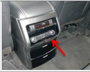
1.5 拆下音响器面板；
