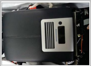
2.15 检查发动汽车引擎检查净化器有没有正常工作, 复原所有连接位螺钉;
