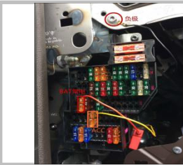
2.8 接 ACC/接正极常电、负极: 在驾驶位置中控台左侧此位置找到原车保险盒, ACC、正极、负极连接于此内;
