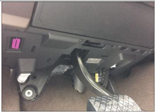
2.4 穿过方向盘下护板,护板内找位置用扎带与原车线束捆绑好。
