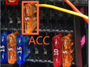
2.12 接ACC 拆下原车 5A 保险丝, 缠上还我司黄色 ACC, 再复原原保险丝 (认准孔位安装)
