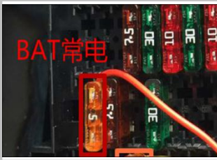
2.11 接正极常电 拆下原车 5A 保险丝, 缠上还我司红色正极, 再复原原保险丝 (认准孔位安装)
