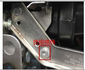
2.9 负极: 负极在保险盒附近位置看到不带油漆的螺栓柱, 装上连接片拧紧;
