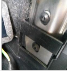
1.5 拆掉手扶箱侧面塑料件下端与手扶箱钣金2颗固定螺钉;
