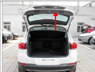
5.1 安装开关：在盖板此位置安装开关；
