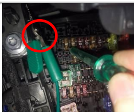
4.10 解码器负极：表针位置接黄色线(剥线夹住即可)
