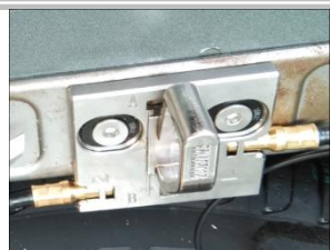
1.4 把锁扣组装上并把螺母、弹簧垫圈、大垫圈锁上，拧紧螺丝；
