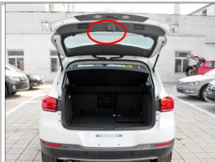
5.4 安装 ECU：在尾门上部找到 ECU 安装点；
