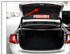
3.1 拆卸上门锁盖板,然后把线束如虚线穿到上门锁盖板;
