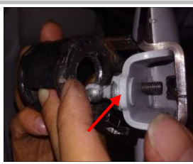
2.8 再把连接支架焊接组与支架焊接组结合用六角头法兰面螺栓 M6_25 拧紧
