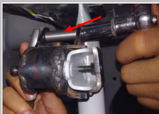
2.10 用工具配合螺栓固定拧紧, 安装方向头固定支架组已安装好
