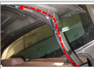
3.5 布线 把2扎布线束(接开关、接门锁信号,)从尾箱右侧沿着摇臂延伸到上门锁(虚线)
