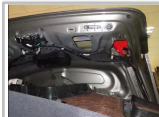
3.4 如图尾箱盖板已取下,盖板妥善保管;
