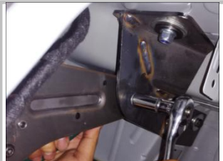
2.18 用工具配合把螺栓拧紧后把开口销安装即可
