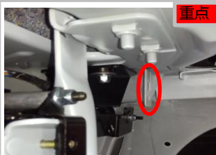
2.20 安装完还原内饰毛毡需注意 以下图中画圈位置锁卡扣时用力过猛会导致变形，变形会导致向里面倾斜，关上门后会跟摇杆干涉
