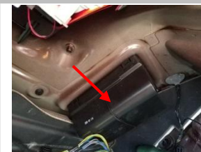
4.2 ECU 放置位置：尾部右侧饰板内下方的原车的预留盒子内
