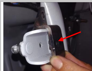
2.7 把支架焊接组装在摆臂上
