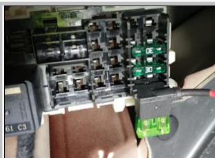
3.11 接正极:将保险丝取电器脚码芯片插入保险盒脚码芯片凹槽内;注意:如图对应位置正极插入,若反插将导致尾门无法使用
