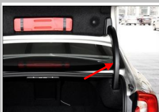
3.2 拆卸塑料扣,原车摇臂上的塑料件拆下,
