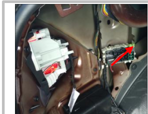
3.7 接正极:看到原车尾箱内部电瓶,我司正极线接原车电瓶正极;
