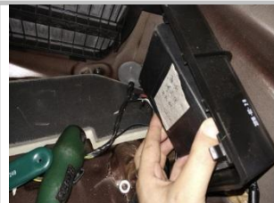
4.5 ECU 粘贴的方向：带有线束插头的一方朝下
