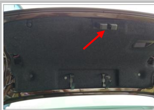
3.15 拆下原车盖板，在门锁附近找到原车信号线位置
