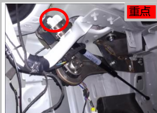
2.12 先把此处位置的棉取下来(左右两边撑杆位置同样取下),然后把尾门打开到最高点再安装另一端的气撑杆,最后把取下的棉复原安装
