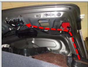
3.6 布线:把2扎布线束(接开关、接门锁信号)延伸到尾箱上门锁扣处,延伸线用胶布或扎带固定好;(虚线)
