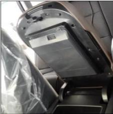
1.13 把我司手扶箱装上,用拆卸的方法反向安装各固定位,塑胶件;
