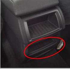
1.4 拆下手扶箱后面此圆圈位置塑料盖板,用撬具在边缘位置小心翘起卡扣定位脱离;
