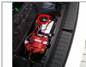
2.10 接负极：负极在尾箱位置看到原车电瓶负极，装上负极连接片拧紧；
