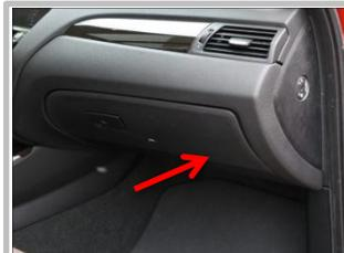
3.1 拆下副驾驶位中控位置装饰件，线束连接在此处；
