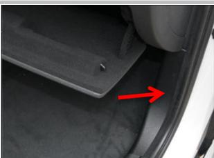
3.3 拆下右侧中控台此面板；负极在内部；
