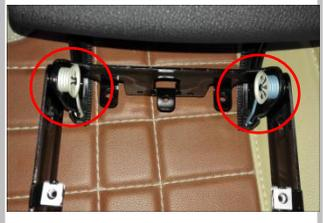
1.12 用我司配的扭簧还原安装,用拆下的金属扣等配合复原安装;
