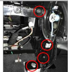
1.9 左右两边对称位置拆下原车螺钉,后续复原安装;
