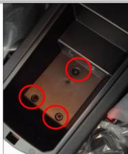
1.2 拆下此3颗螺丝，妥善保管，后续需复原，然后拆下塑料件；
