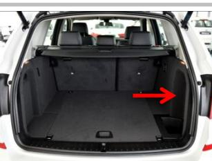
2.11 拆下尾箱右侧内部盖板；
