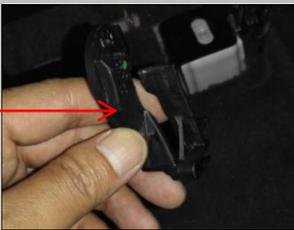
1.8 如图使用,取下的原车连接件,后续需复原安装;
