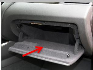
3.2 将图中所示副驾驶室中控料盖板拆下，保险盒在内部；
