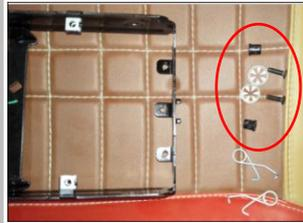
1.11 拆下原车配件需还原,扭簧用我司配的安装;
