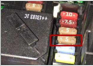
3.10 接正极常电：拆下原车 5A 保险丝，缠上还我司红色正极，再复原保险丝（认准孔位安装）
