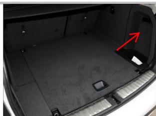
2.2 布线：拆下尾箱右侧盖板；
