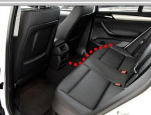
2.6 布线：如图示，在后排座椅箭头线束走向布线，隐藏在座椅内侧；
