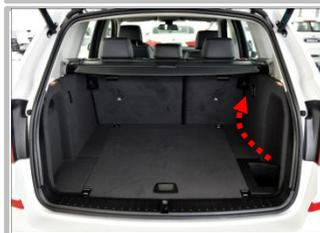
2.4 布线：如图示意，线束从尾箱右侧延虚线示意走向，到右侧后排座椅底下；
