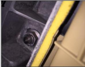
3.13 负极：副驾驶室右侧内部附近位置看到不带油漆的螺栓柱，装上负极连接片拧紧；
