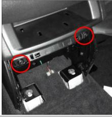
1.5 塑料盖板后,把此处两颗螺钉拆下,所有拆下的原车螺钉都妥善包管,后续需全部复原安装;
